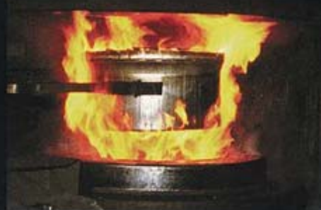
由8000吨压力机压锻成车轮形状。再进行热处理将机械强度增至最大。
